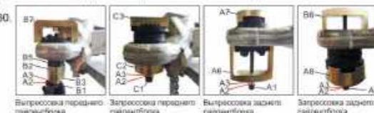
Выпрессовка переднего сайлентблока. Выпрессовка переднего сайлентблока. Выпрессовка заднего сайлентблока. Выпрессовка заднего сайлентблока.
